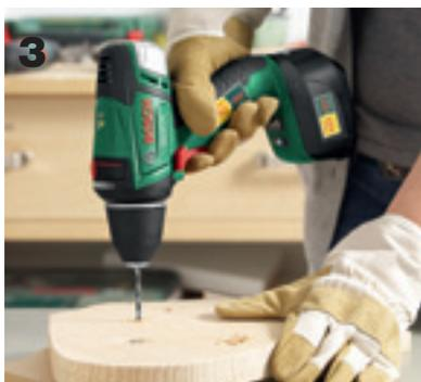
Mit dem Akku-Bohrschrauber und dem Holzbohrer an den Markierungen jeweils ein Loch durchbohren.
