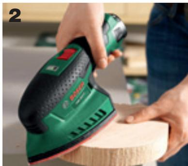
Die Kanten aller ausgesägten Stücke mit dem Multischleifer nachschleifen. Den Bären, wie auf der Schablone, ohne Mund, Ohren und Nase aufeinanderstapeln. An dem jeweils darunterliegenden Brett mit Bleistift zwei Punkte zum Verbinden markieren.
