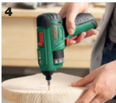
Die einzelnen Holzplatten durch die Löcher mit dem Akkuschauber zusammenschrauben.
